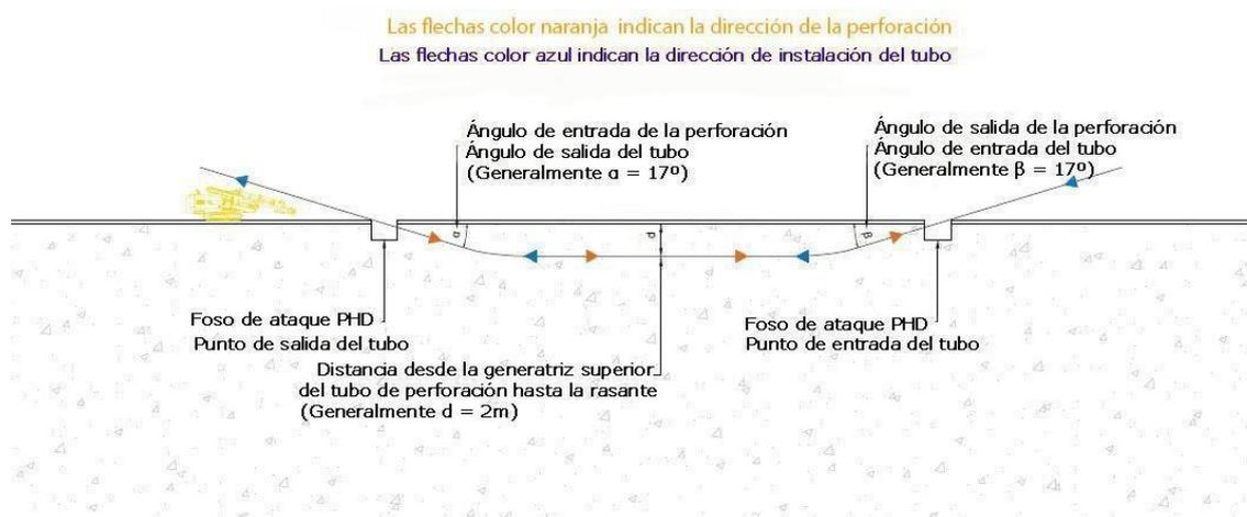
Figura 4. Esquema de perforación e instalación del tubo cruzamiento en la carretera CL-629.
